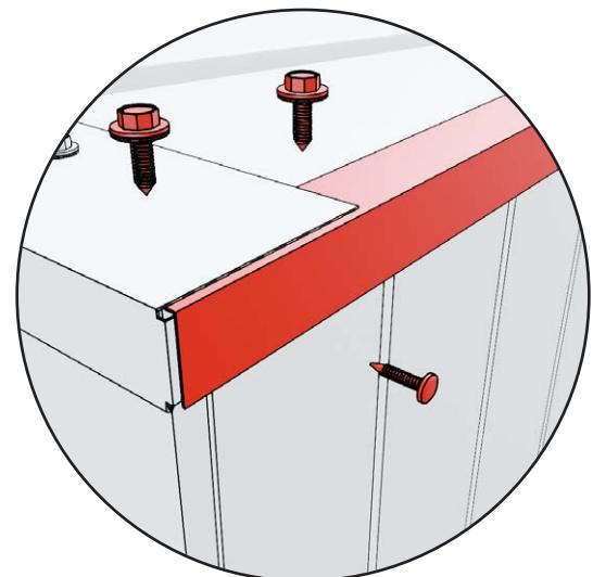
5. Assurez-vous que les solins latéraux ont été retirés des parois devant être assemblées. Il est possible que les solins soient difficiles à retirer étant donné la présence d'un joint de silicone entre le solin latéral et le solin frontal.
