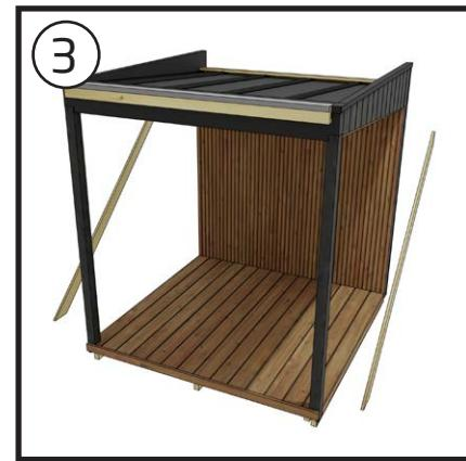
Verwijder het beschermingsmateriaal zoals aangeduid op de afbeeldingen. Multiplexplaten en platen zijn met schroeven vastgemaakt.
