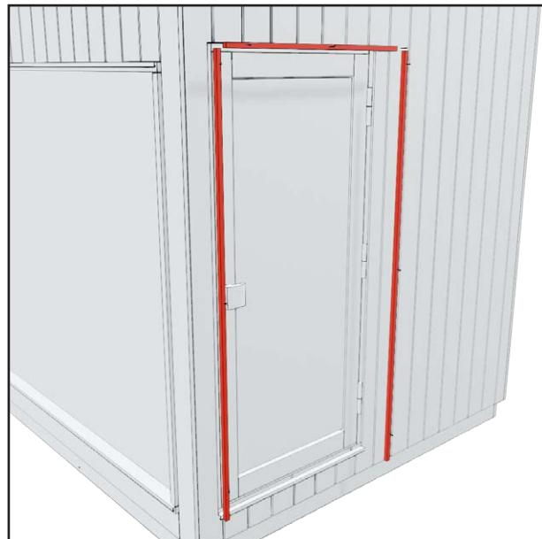
2. Varmista että oven ympärillä olevat smyygilaudat ovat poistettu.
