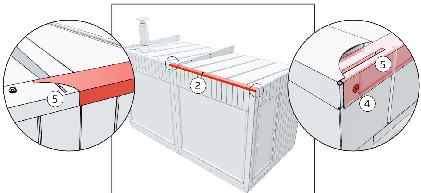
2. Platzieren Sie das Firstblech des Moduls auf dem Dach. Das Firstblech des Moduls überlappt das der Sauna um etwa 10 cm.
