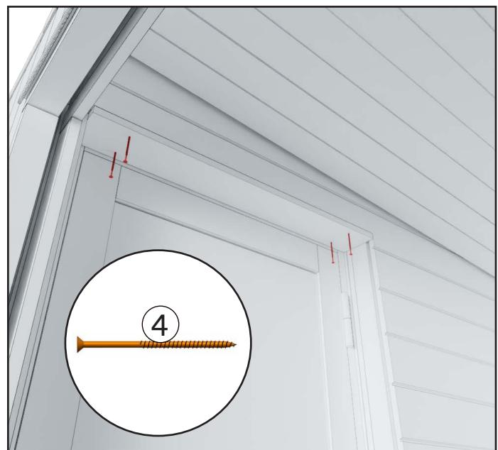
2. Placez une courte planche de recouvrement sur l'encadrement supérieur de la porte afin que le bord avant de la planche soit au même niveau que la paroi intérieure du module.
