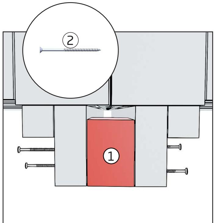
2. Insérez la pièce de remplissage entre les supports de transport.
