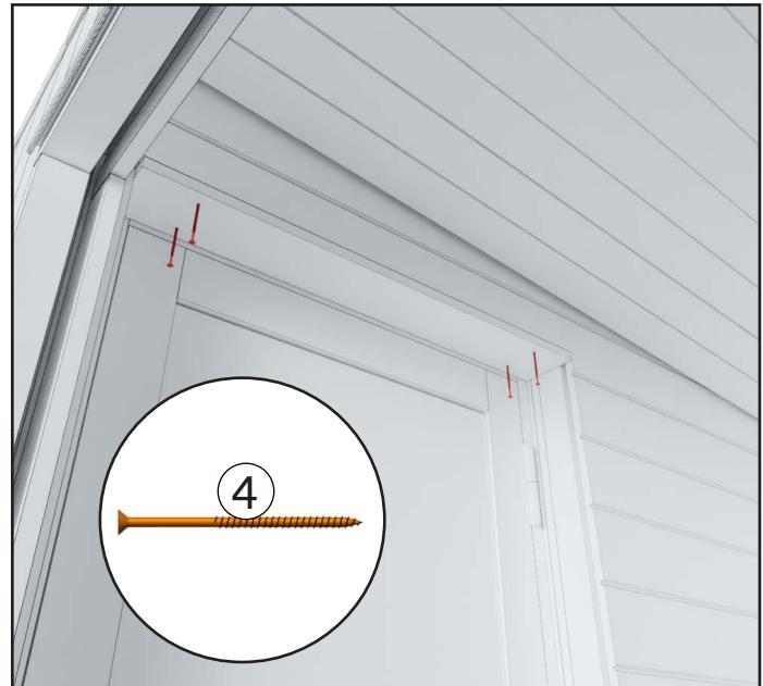
2. Bevestig de korte afdekplaat boven op de deuropening. De afdekplaat wordt tegen het kozijn van de sauna geplaatst.
