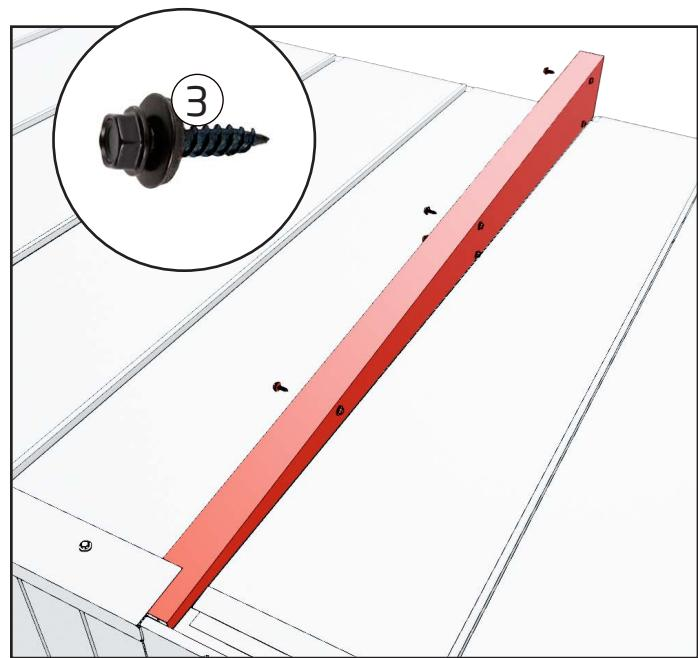
1. Plaats de U-profielplaat tussen de modules en maak deze vast met schroeven. Aan beide kanten zitten er vijf schroeven.
