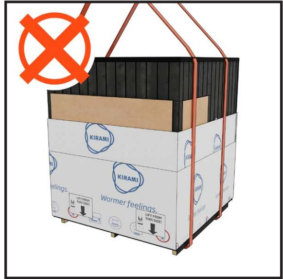
Heben Sie die Module niemals mit seitlich angebrachten Hebegurten an.
