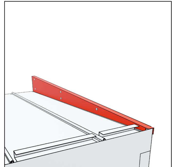
6. Bevestig de dakrandlijst aan de zijkant aan de laatste module van de reeks via dezelfde punten waar deze voordien was bevestigd.
