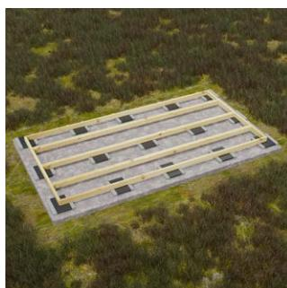
Anschließend empfiehlt es sich, eine Unterkonstruktion (aus langlebigem Material) auf die Betonfliesen zu legen (vgl. Abbildung unten). So können die Module leichter auf dieselbe Höhe gebracht werden.
