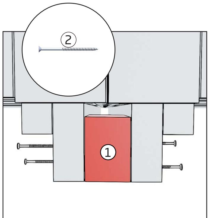
2. Schieben Sie das Füllstück zwischen die Unterbalken.
