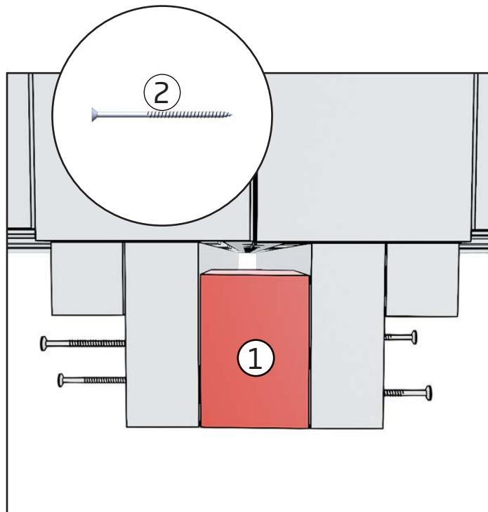
2. Laita täytepala moduulien kuljetustukien väliin.
