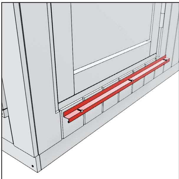
3. Vergewissern Sie sich, dass an der Unterseite der Tür keine Tropfkante vorhanden ist. Entfernen Sie sie, falls erforderlich.
