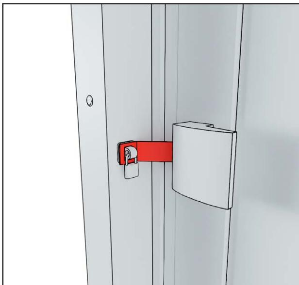
Wenn Sie ein Terrassenmodul neben die Sauna montiert haben, muss an der Innenseite des vertikalen Pfostens eine Riegelhalterung angebracht werden. Damit kann die Sauna mit einem Riegel vorschriftsmäßig verriegelt werden.
