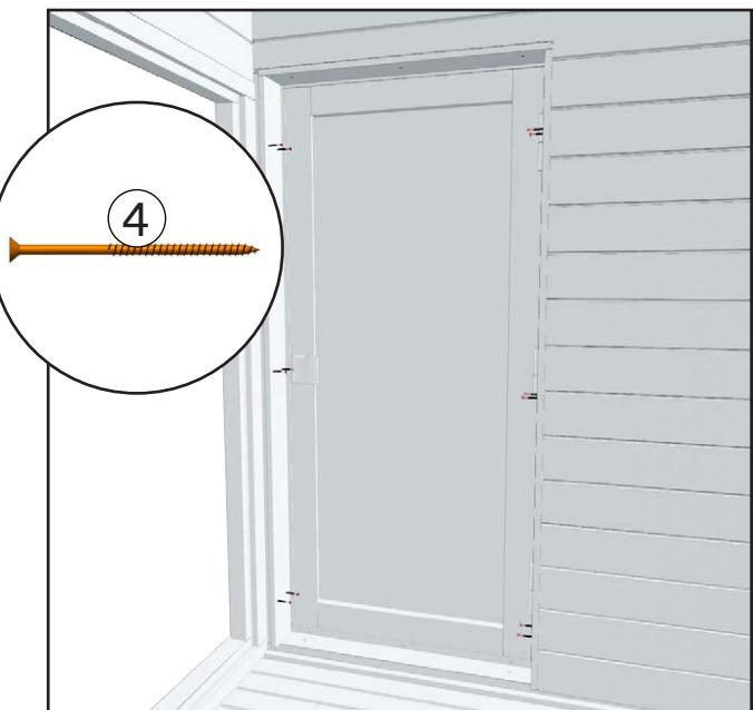
3. Fixez les plus longues planches de recouvrement sur les encadrements latéraux afin que le bord avant des planches soit au même niveau que la paroi intérieure du module. Fixez les planches de recouvrement (prépercées) à l'aide de six vis.
