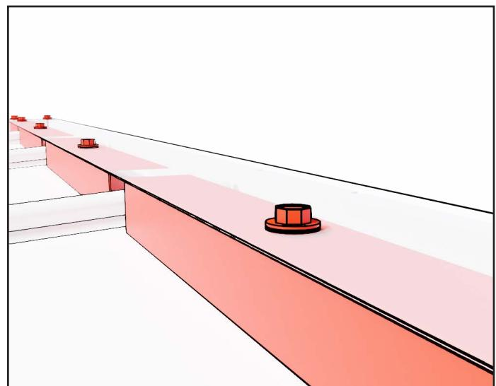
3. Fixez le solin sur les bords avec deux vis de chaque côté. Fixez également le solin frontal aux solins d'étanchéité du toit.
