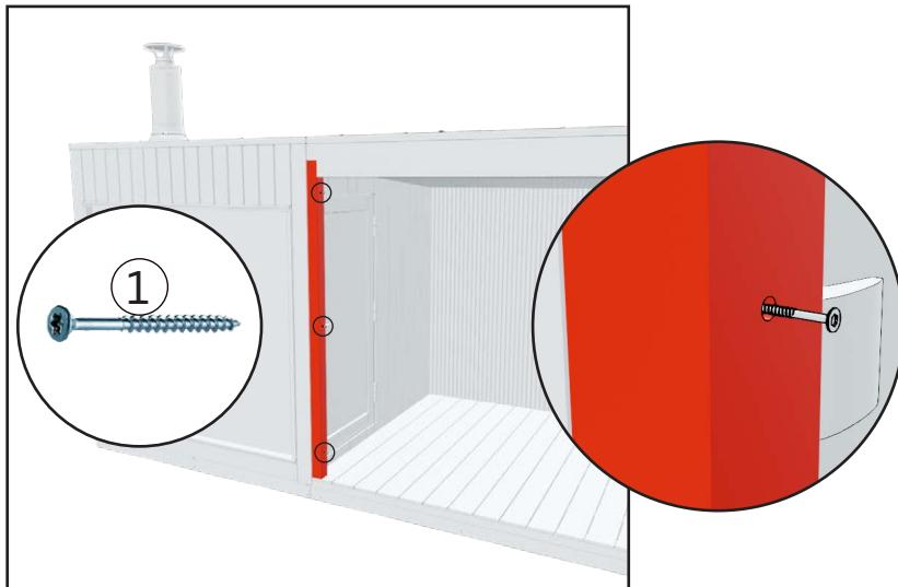
1. Attachez le module terrasse avec trois vis en partant du pilier pour atteindre le module adjacent. Les trous des vis sont préforés dans le pilier.
