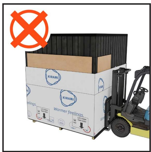
Rij de heftruck nooit langs de zijkant van de module. Zo wordt de module beschadigd.
