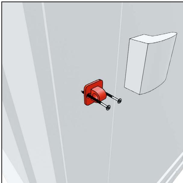
1. Säkerställ att motjärnet till regeln inte har monterats i bastun. Demontera motjärnet vid behov.
