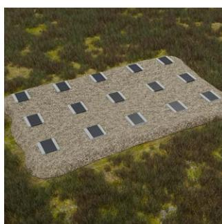
Suosittelemme asettamaan kovan alustan päälle betonilaattoja lisäkorotukseksi sekä laattojen päälle kattohuopaa (bitumihuopaa) laatan leveydelle.
