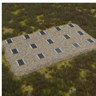
Nous recommandons de placer des dalles de béton par-dessus la surface dure accueillant les modules afin de la surélever (voir l'illustration des fondations) et de recouvrir toute la largeur de ces dalles de feutre de toiture (feutre bitumé).
