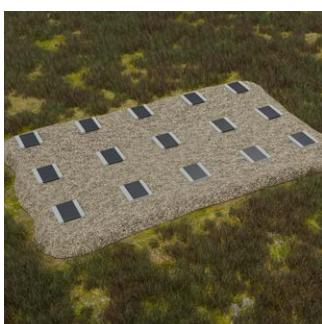
Under modulerna rekommenderar vi att du lägger betongplattor på den hårda ytan för att ytan ska bli högre och att lägga takfilt (bitumentak) ovanpå plattorna i hela plattans bredd.
