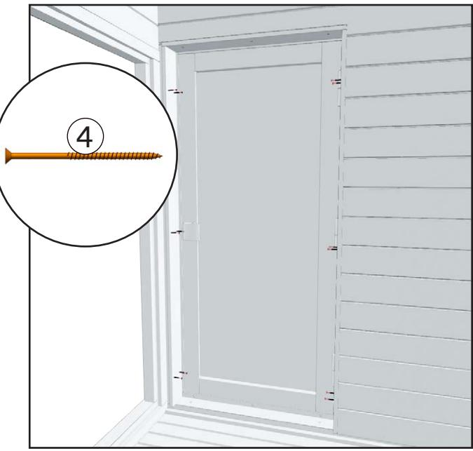
3. Bevestig de lange afdekplaten aan de zijkanten van de deuropinging, waarbij de voorkant van de platen op hetzelfde niveau zitten als de binnenste wand van de module.
