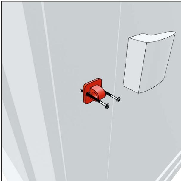
1. Vergewissern Sie sich, dass die Halterung des Saunatürverschlusses nicht angebracht ist. Gegebenenfalls entfernen.
