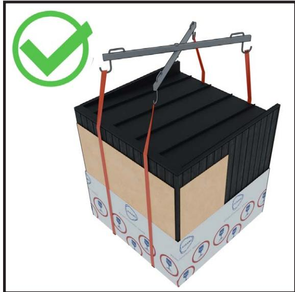
Placer les sangles de l'avant vers l'arrière du module.
