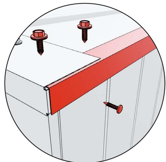
5. Zorg ervoor dat er op de te verbinden wanden geen zijdelingse daklijsten meer zitten. Het kan zijn dat de daklijst stevig vastzit door een siliconen naad tussen de dakrandlijst aan de zijkant en die aan de voorkant.
