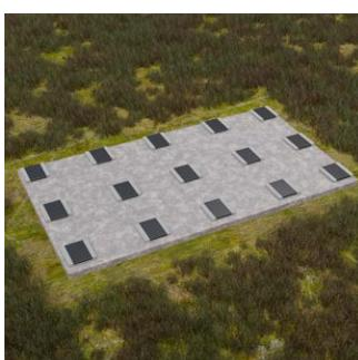
När bottnen av modulerna exponeras tydligt för luft, ventileras och torkar den bra.
