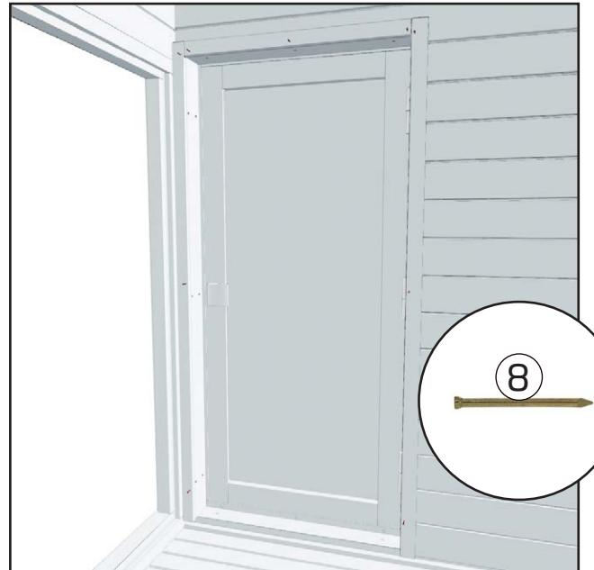
4. Gebruik ten slotte afdekstrips om de open ruimte tussen de afdekplaten en de wand te verbergen.
