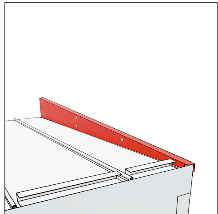
6. Fixez le solin latéral sur le dernier module de la série à assembler aux mêmes points d'attache que ceux précédemment utilisés.
