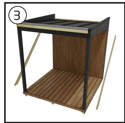
Avlägsna skydden såsom på bilden. Skyddsfaner och plankorna är fästa med skruvar.
