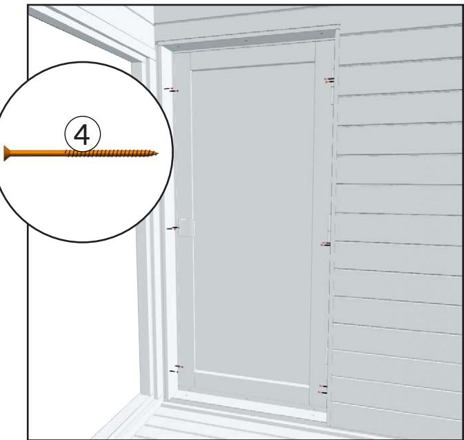
3. Befestigen Sie die langen Futterbretter an den Seiten des Türdurchgangs. Die Futterbretter werden am Türrahmen der Sauna angesetzt.
