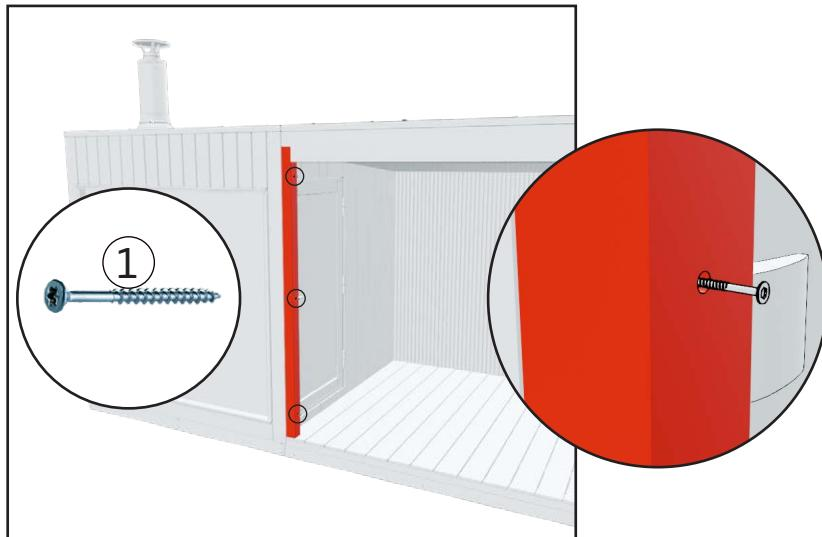
1. Bevestig de terrasmodule met drie schroeven vanaf de verticale balk naar de aanpalende module. In de verticale balken zitten er voorgeboorde gaten.
