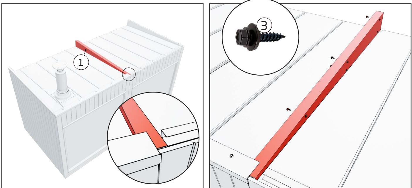
1. Placez et fixez la plaque de profilé en U en chevauchement des modules à l'aide de vis. Il y a cinq vis de chaque côté.
