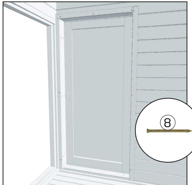
4. Enfin, utilisez les bandes de protection pour masquer le trou entre les planches de recouvrement et la paroi.
