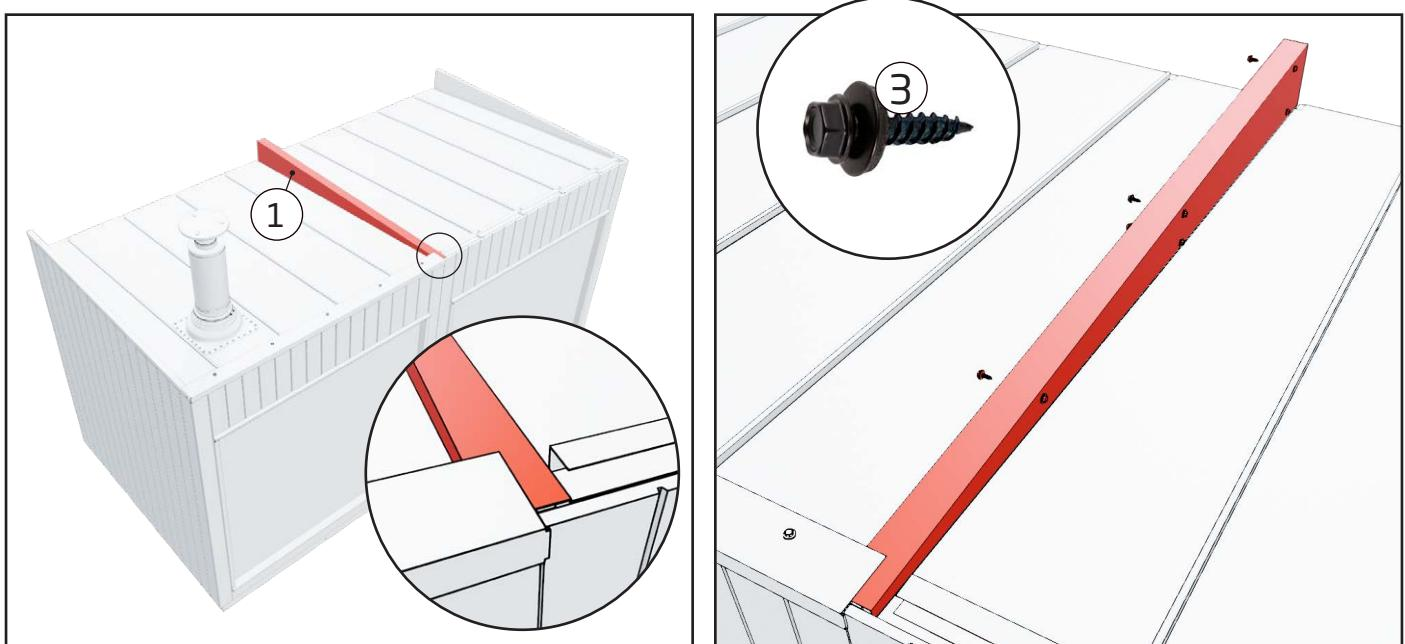
1. Asettele ja kiinnitä U-pelti moduulien väliin. Käytä kiinnittämiseen ruuveja. Molemmille puolille tulee viisi kappaletta ruuveja.
