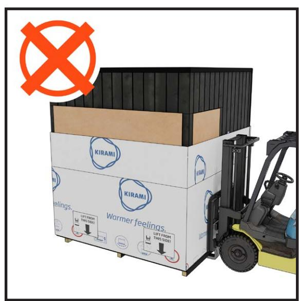
Ne placez jamais les fourches sous le module par le côté de celui-ci. Ce mauvais placement des fourches endommagera le module.
