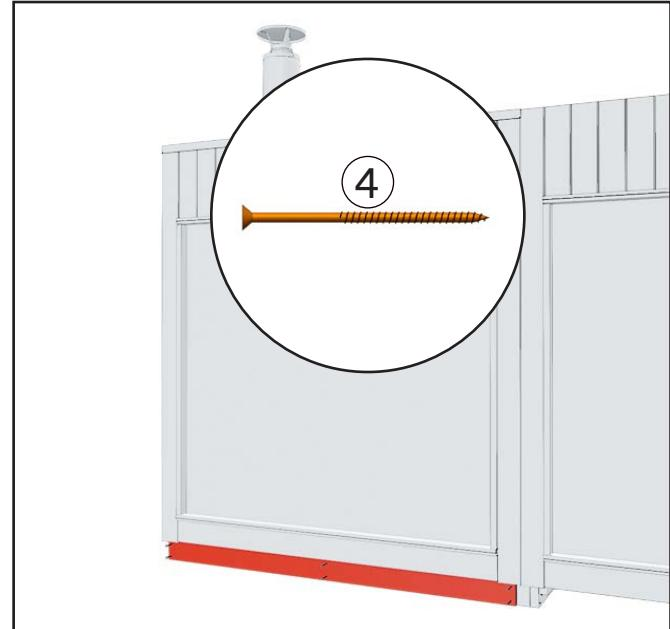
5. Bevestig de plinten aan de transportbeugels van de sauna aan voor- en achterzijde.
