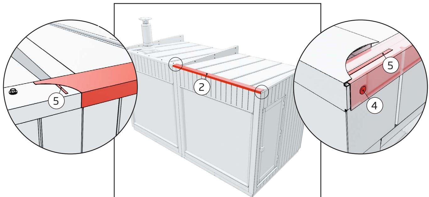
2. Placez la bande de solin du module sur le toit. La bande de solin doit recouvrir le solin en dessous d'environ 10 cm.
