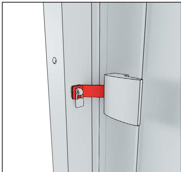
Om du har monterat en terrassmodul intill bastun, måste du på insidan av den vertikala stolpen fästa ett motjärn, varvid bastun kan låsas med regeln enligt bestämmelserna.
