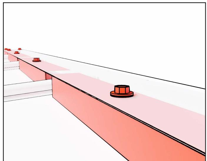
3. Maak de daklijst aan de randen vast met twee schroeven aan elke kant. Bevestig vervolgens de dakrandlijst aan de afdichtingslijsten op het dak.
