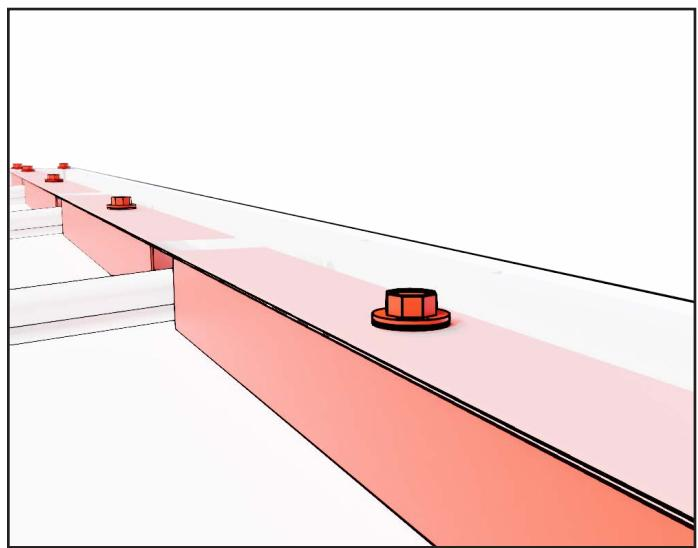
3. Fäst takfotsplåten i kanterna med två skruvar per sida. Fäst takfotsplåten också i vindskydden på taket.
