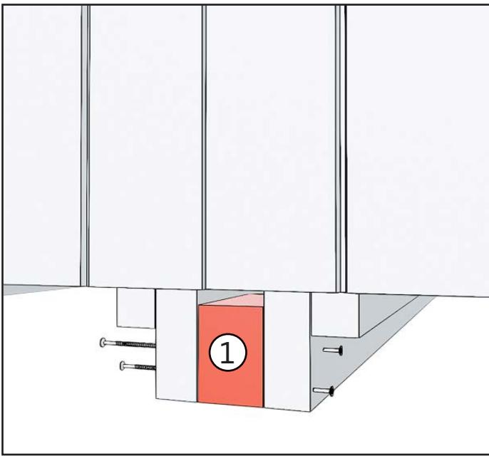
4. Fixez la pièce de remplissage à l'arrière des modules de la même manière que lors des étapes 2 et 3.
