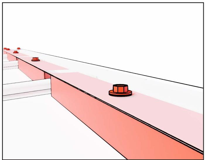
3. Kiinnitä räystäspelti reunoihin kahdella ruuvilla per puoli. Kiinnitä räystäspelti myös katolla oleviin tuulisuojiin.
