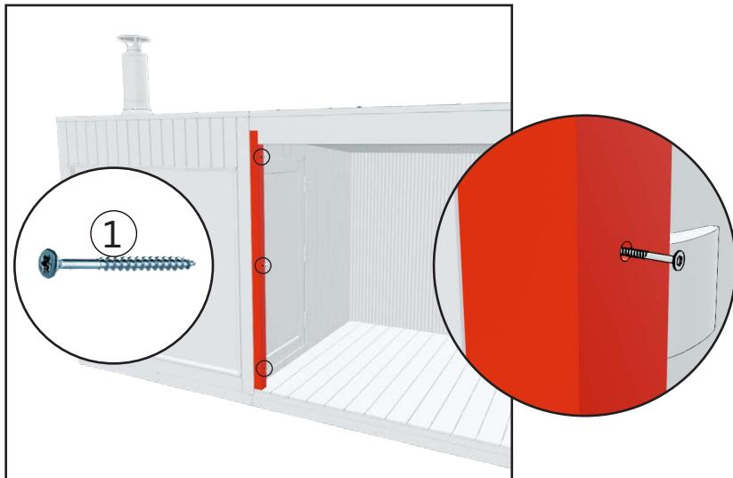
1. Fäst terrassmodulen i den intilliggande modulen med tre skruvar i den vertikala stolpen. I de vertikala stolparna finns färdiga skruvhål.
