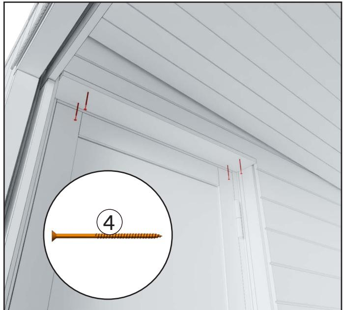
2. Befestigen Sie das kurze Futterbrett im oberen Teil des Türdurchgangs. Das Futterbrett wird am Türrahmen der Sauna angesetzt.
