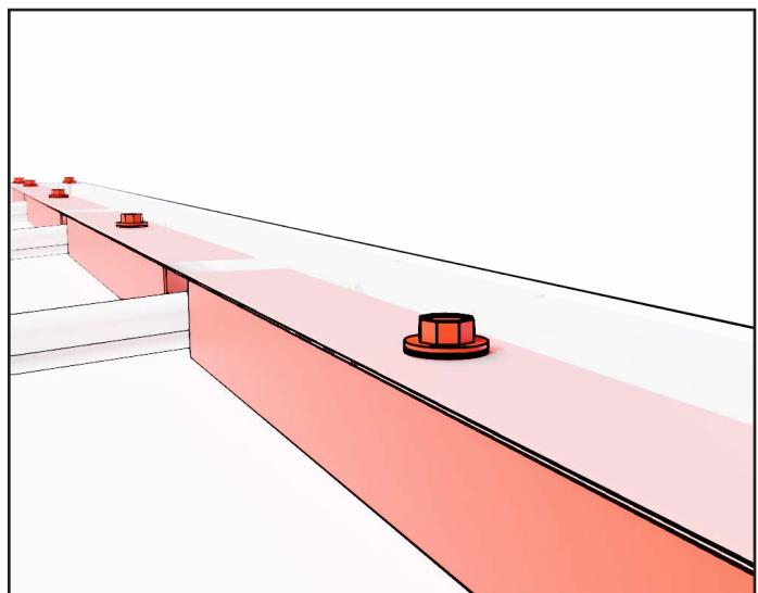
3. Befestigen Sie die Traufbleche an den Rändern mit zwei Schrauben auf jeder Seite. Befestigen Sie die Traufbleche auch an den Dichtungsblechen auf dem Dach.
