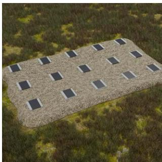
Wir empfehlen, Betonfliesen auf die harte Oberfläche unter den Modulen zu legen, damit die Module leicht erhöht stehen (vgl. Abbildung des Fundaments), und diese Betonfliesen jeweils in ihrer gesamten Breite mit Dachpappe (Teerpappe) zu versehen.
