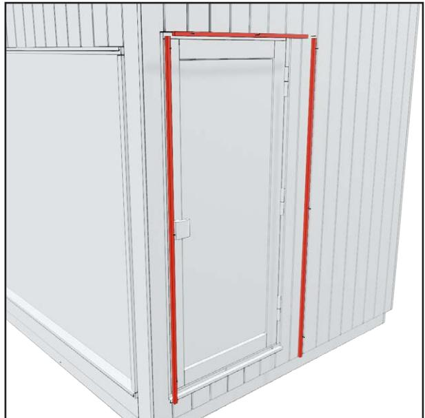
2. Stellen Sie sicher, dass die Zierbekleidung von den Türrahmen der zu verbindenden Wände entfernt wurde. Gegebenenfalls entfernen.
