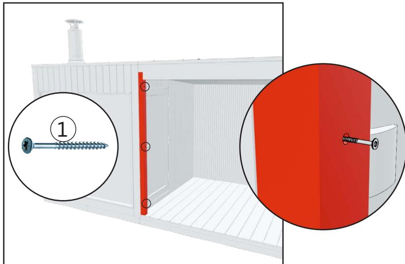
1. Kiinnitä terassimoduuli kolmella ruuvilla pystytolpasta viereiseen moduuliin. Pystytolpissa on reiät valmiina.
